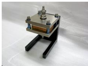
同軸励振平衡形円板共振器の外観 (5~110GHz 測定用)
