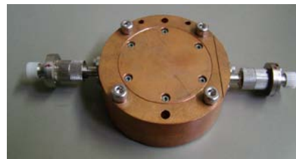
周波数依存性測定用マルチモード TE 011 空洞共振器
