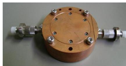
周波数依存性測定用マルチモード TE<sub>011</sub> 空洞共振器
